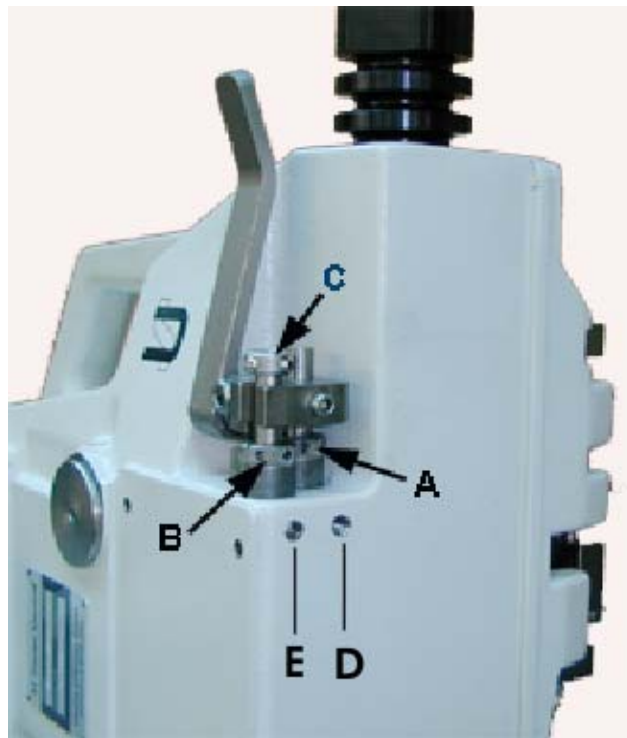
LOCATION OF LIMIT SCREWS AND LOCK NUTS FOR CHAINING SECTION AND PRESSER FOOT SETTING. POSITION DER ANSCHLAGSCHRAUBEN UND KONTERMUTTERN FÜR KETTELTEIL UND DRÜCKERFUSS.
